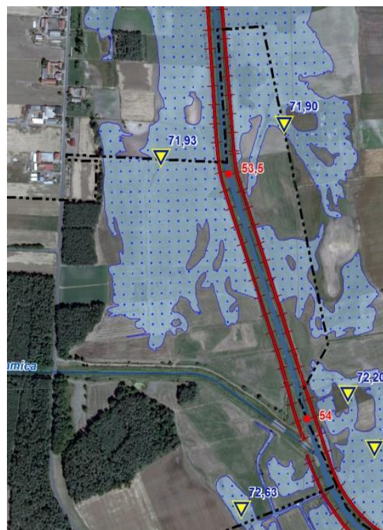
Rys. 11 Symulacja zasięgu podtopienia terenu
